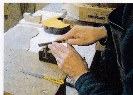
103 Filing top nut string grooves
